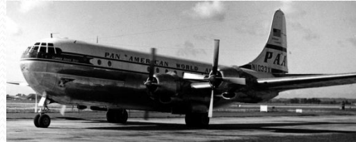
Le Boeing 377 Stratocruiser (à cabine pressurisée), mis en service en 1949. Avion dérivé du B29
