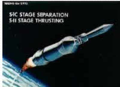
Séparation 1er étage
